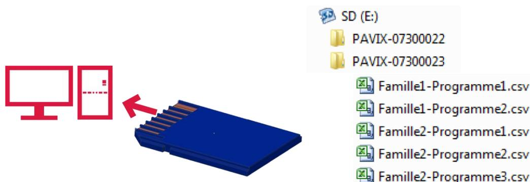
Figure 48: SD sur PC et arborescence SD
