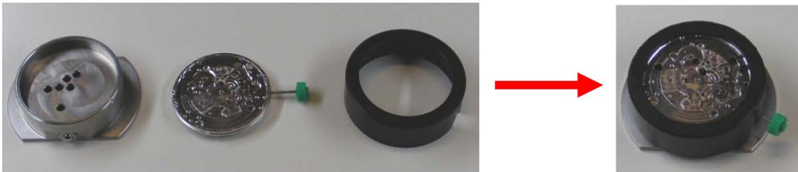
3. Uhrwerk auf Ebatest legen. Mit dem Spiegel kann ohne Weiteres das richtige Werkhalterloch auf die Welle gelegt werden. (Jedes Loch entspricht der Position eines Uhrwerkdrehteils und ist diesem Uhrwerk eigen.)
