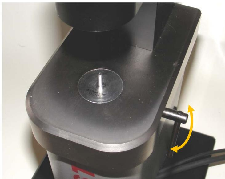
Spiegel entfernen und Hebel drehen, um Gegendorn freizugeben.
