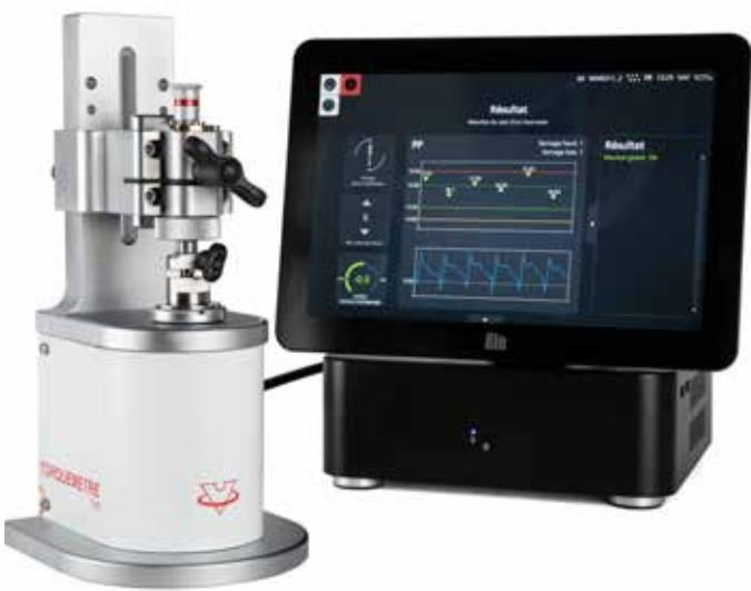
**TORQUEMETRE TVD** est un dispositif de précision destiné au contrôle périodique et au réglage des tournevis dynamométriques utilisés dans l'industrie horlogère et microtechnique. Cet appareil est une évolution spécifique du **TORQUEMETRE VOH** avec système de mesure motorisé assurant une mesure du couple et du déplacement, affranchie du facteur humain.
