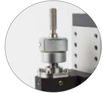
Capteur de couple avec trois étendues de mesures sélectionnables
