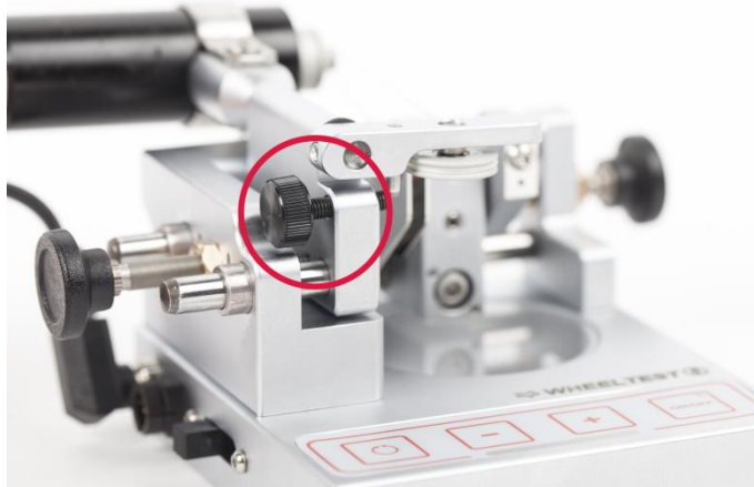
Figure 9: Vis de réglage de la butée courroie
